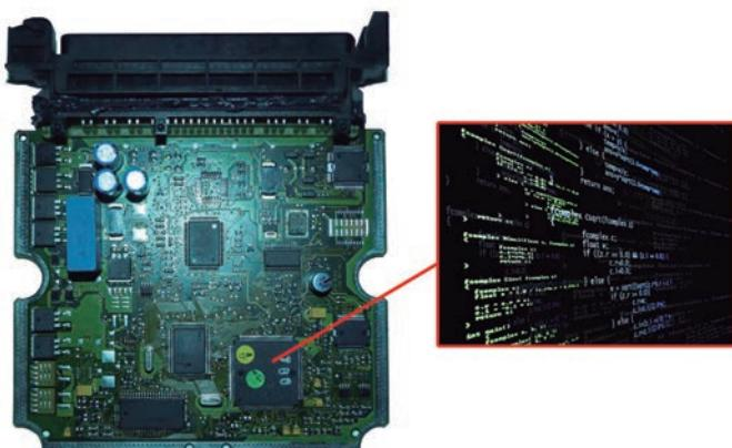
**Flash memorija** sadrži prikaze ili kartografiju, tj. tablice brojčanih vrijednosti koje dvije vrijednosti povezuju s trećom. U slučaju upravljačke jedinice motora, to se odnosi na kontrolu ubrizgavanja, tlaka turbine, zasićenja filtra čestica itd. Mikroprocesor će očitati podatke iz ove memorije kako bi točno izvršio upute, primjenjujući potrebne ispravke temeljene na signalima zaprimljenim od senzora, sve dok se ne postigne sukladnost omjera triju vrijednosti.
