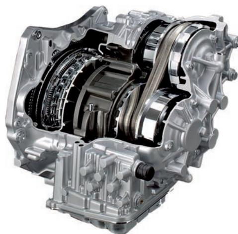
Kada se kontrolira otvaranje ili zatvaranje ploča, mijenja se učinkoviti unutarnji promjer i ostvaruju se različiti prijenosni omjeri. Prijenos sile između dvije remenice izvodi se putem remena, tako da se postupno mijenja prijenosni omjer kod promjene promjera remenica,
