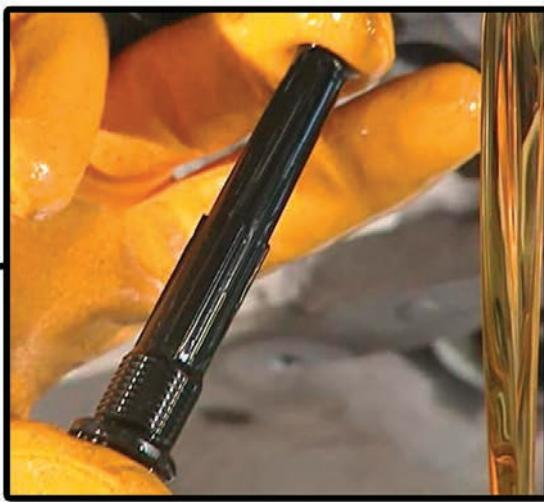
Nakon što ste ispraznili ulje i zamijenili filter, ponovno namjestite kanilu i zatim zavijte alat za punjenje ulja i dodajte 5,5 litara ulja. Nakon punjenja izvadite alat, pokupite ulje koje se možda prelilo, a kad prestane kapljati, ručno pričvrstite vijak.
