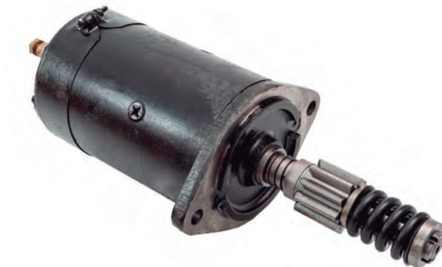
Koriste se na motociklima s malim cilindrom, a ponekad i na teškim ili nepokretnim strojevima. Spajanje se postiže inercijom samog zupčanika kada započne rotacija i spiralnim zupčanicom na osovini. Ima neke sličnosti sa sustavom vilica, ali bez mehanizma prisilnog spajanja (relej, vilica i pogonski mehanizam). Relej struje u ovom se slučaju nalazi izvan elektromotora i električno funkcioniра samo kao prekidač za daljinsko upravljanje za velike struje.
