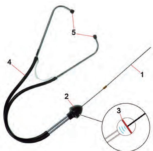
korištenje stetoskopa. Uobičajeni zvuk ove tri komponente bitno je različit pa se one ne mogu uspoređivati. Zvuk pumpe za vodu tiho zuji, valjak za zatezanje remena ispušta fino i ravnomjerno zviždanje, a zatezač lanca ima tuge i ritmične vibracije. Svaka anomalija u tonu ili varijacija zvučnog uzorka ukazuje na neispravno stanje određene komponente.
