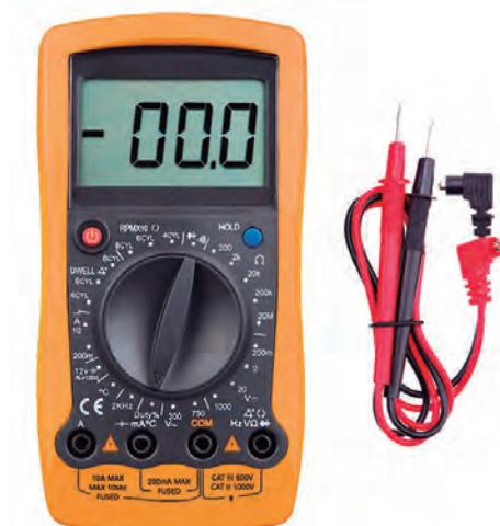
Ovo je važan alat za mjerjenje i ispitivanje nekoliko električnih veličina, a poznat je i kao multimeter. Stoga je neophodan za dijagnozu električnih i elektroničkih sustava i komponenata u vozilima. U automobilskom sektoru koristi se za mjerjenje razlika napona, struja, radnih frekvencija i električnih otpora, između ostalog, za ispitivanje signala, napajanja i stanja mnogih komponenata.
