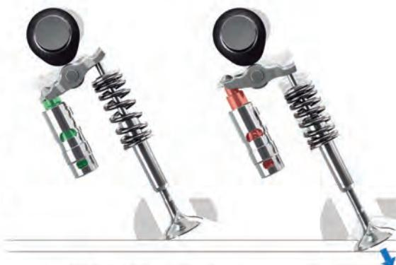
Hidraulični podizač bez pritiska ulja
