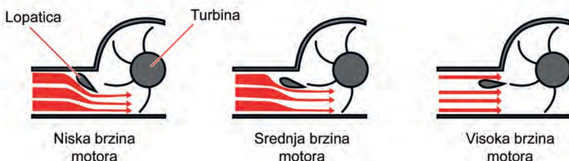
Motorom se upravlja putem radnog ciklusa u postocima uz pomoć pravokutnog signala fiksne frekvencije i promjenom polariteta za promjenu smjera vrtnje. Signal povratne veza po položaju lopatica
