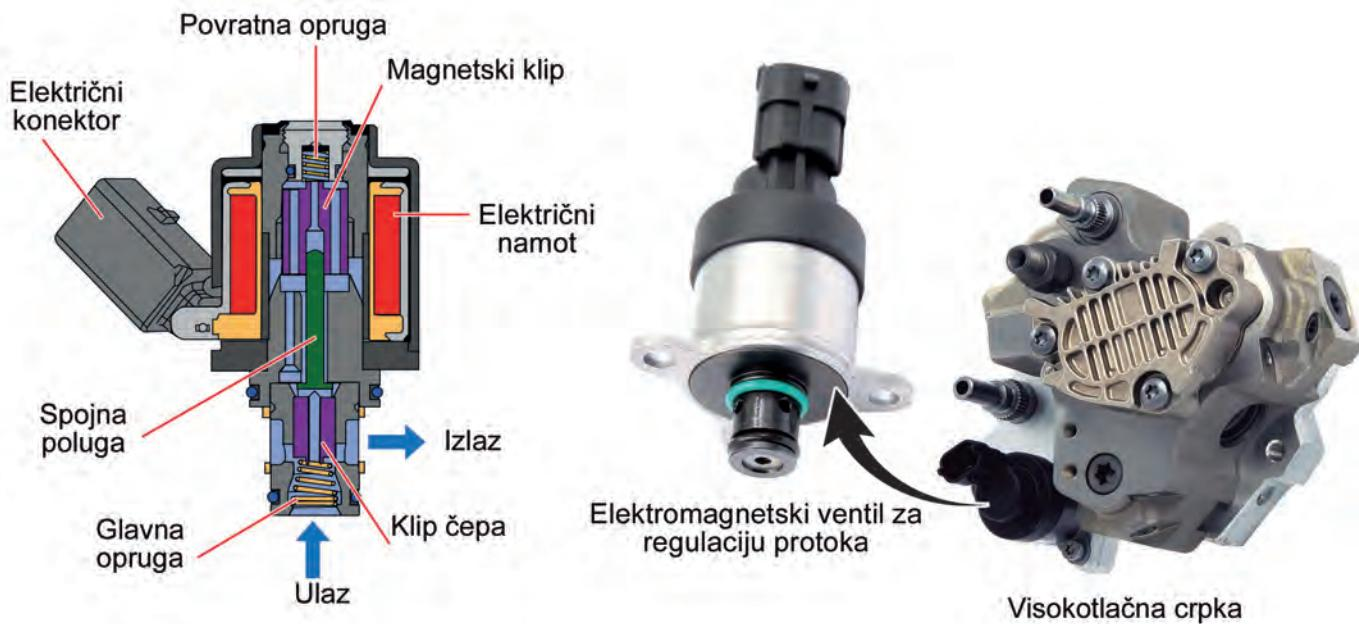
Ovo je elektromagnetski ventil s promjenjivim poprečnim presjekom koji ovisi o jačini magnetskog polja stvorenog u zavojnici s bakrenim vodičem. Ovaj mirni položaj je otvoren i omogućava protok goriva u
