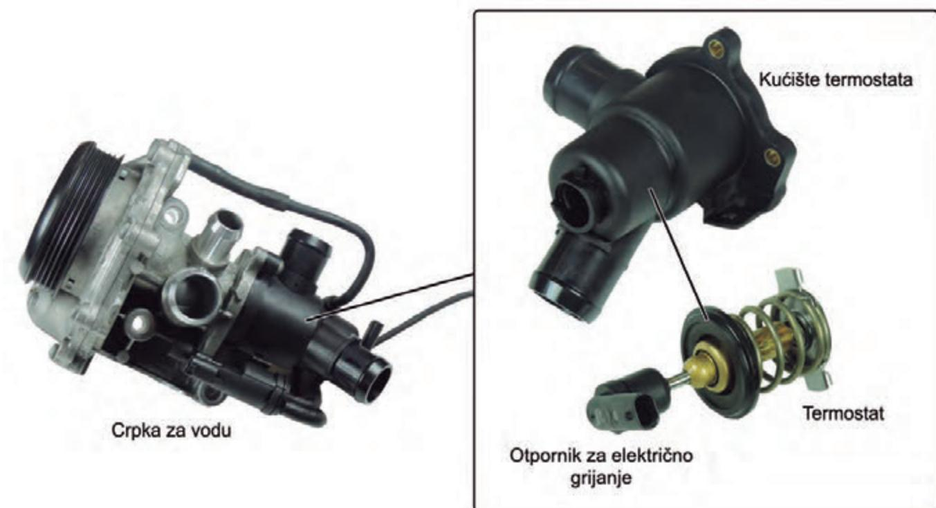
Ova vrsta termostata koristi se za regulaciju protoka rashladnog sredstva unaprijed u skladu s opterećenjem motora i brzinom vozila. Napajanje se dovodi na otpornik kako bi se promijenio poprečni presjek otvora u očekivanju značajnog povećanja nakupljene topline u glavi cilindra i u bloku motora.
