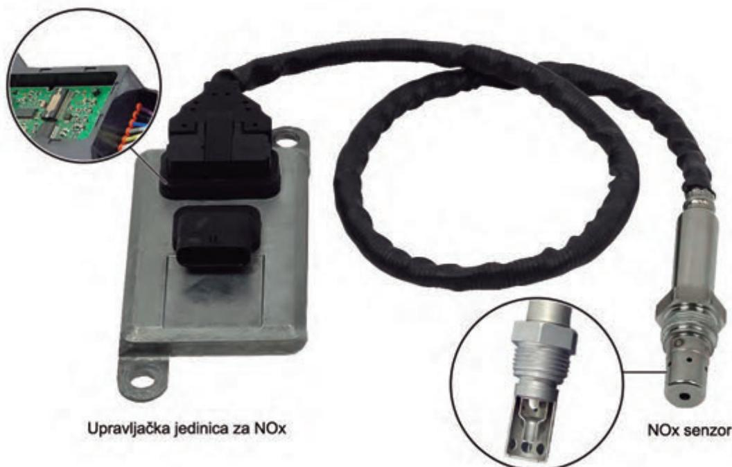
Jedinice NOx senzora dijele podatke iz aktivnog mjerena s upravljačkom jedinicom motora preko CAN sabirnice kako bi se izračunao učinkovitost redukcije katalizatora i pratio rad SCR sustava.
