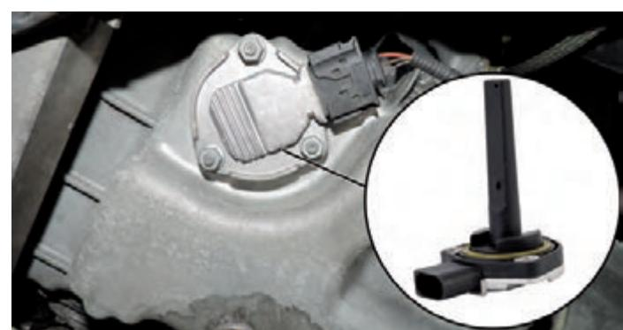
U funkciji senzora razine, oni rade kao kondenzator čiji kapacitet se mijenja u ovisnosti o razini ulja koje ima funkciju dieletričnog elementa. Neki senzori uz mjerjenje razine mjere i kvalitetu maziva uz pomoć drugog kondenzatora koji je u potpunosti uronjen u ulje.
