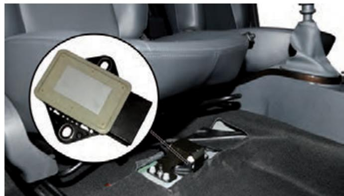
Svrha senzora za **zanošenje i brzinu zanošenja** je mjerjenje brzine rotacije vozila oko njegove vertikalne osi. Signal se koristi u upravljačkoj jedinici za izračunavanje momenta zanošenja, sile kojoj se treba suprotstaviti radi vraćanja stabilnosti vozila.
