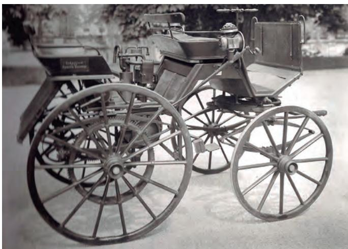
1889. godine, prvi automobil koji je prodala tvrtka Daimler-Maybach bio je pokretan V-dvcilindričnim motorom i ugrađenim četverostupanjskim mjenjačem, to je ujedno bio i prvi mjenjač brzina. Na tu je ideju došao Wilhelm Maybach, tehnički direktor tvrtke.
