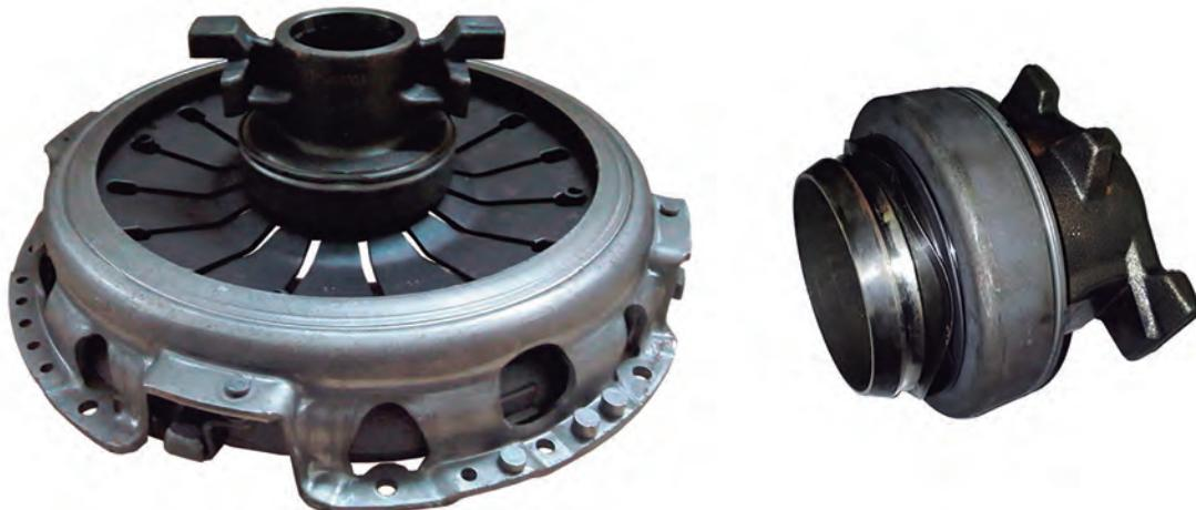
Potisni ležaj pomiče se na glavčini ili vodilici koja okružuje ulaznu osovinu mjenjača. Vodilica drži potisni ležaj u središtu tijekom njegovog pomaka, tako da leži ravno i centriran na nožicama membranske opruge i pomiče
