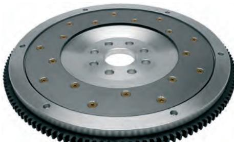
Kada je klip u GMT (gornja mrtva točka) položaju motora, klin radilice je u ravnoj liniji i ne stvara moment okretanja na radilici. Trenutak kasnije, kako se klip spušta, klipnjača formira određeni kut i sila potiska djeluje na osovinu radilice kako bi pokrenula radilicu, pri čemu nastaje moment okretanja. Isporuka snage očito je nepravilna i funkcija je zamašnjaka osigurati pravilan rad ove isporuke.
