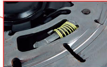
Posebno treba istaknuti postavljanje samo-podešavajućih potisnih ploča. Zbog njihovih radnih karakteristika, treba ih postaviti u blokirani mehanizam / položaj za kompenzaciju otporan na habanje i bez pritiska na disk. Ako to ne učinite, možete oštetiti mehanizam za podešavanje
