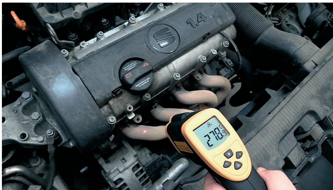
Reakcija oksidacije CO i HC je endotermna, pa se plinovi zagrijavaju dok prolaze kroz katalizator. Temperaturna razlika na izlazu i ulazu katalitičkog pretvarača mora biti između  $50-70^\circ\text{C}$ , pod uvjetom da je omjer smjese prihvatljiv, količina CO na ulazu katalitičkog pretvarača veća od 0,4% i  $\text{CO}_2$  više od 13%.
