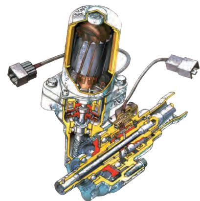
Provjerite funkcioniira li opskrba sustava električnom energijom prema uputama proizvođača te dolazi li do pada napona tijekom servoupravljanja.
