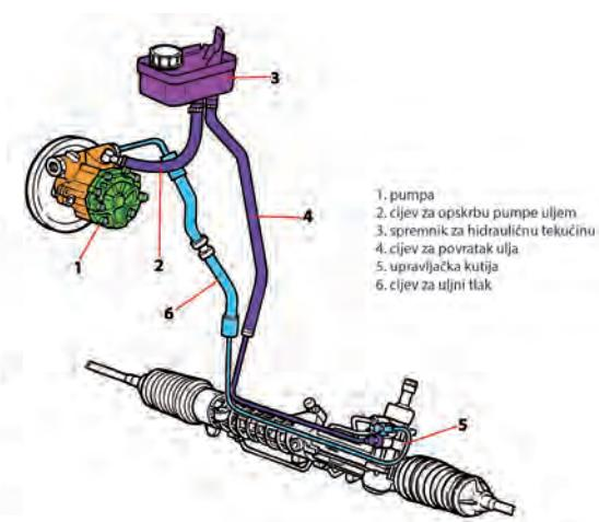
Razvodnik otkriva putanje tekućine između dviju komora te u skladu s njima uzrokuje pomicanje klipova prema okretu koji vozač zatraži.
