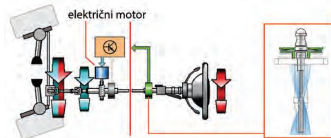
moment koji se dostavlja električnom motoru postaje intenzivniji, što omogućuje nesmetano okretanje na upravljačkoj letvi.
