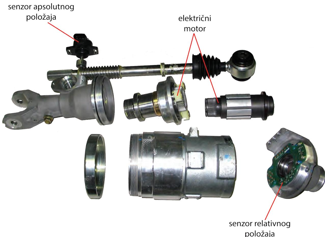
Sve sastavnice upravljačkog sustava i njegovi dijelovi su neprestano izloženi različitim opterećenjima uslijed tlaka i temperature koje vozilo generira pri vožnji. Nakon što vozilo prijeđe određenu kilometražu, strojni dijelovi upravljačkog sustava često popuste, zategnu se, ili se čak polome, što dovodi do kvarova.
