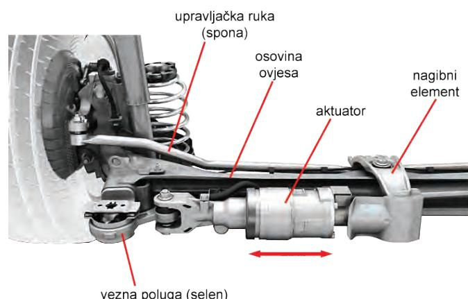
Pričvršćenje pokretača na kraj osovine postiže se pomoću gumenog selena, dok se na kraj nagibnog sustava učvršćava dvostrukim kuglastim zglobom. Jedan zglob gumenog selena postavlja se na vrh upravljačkih zglobova, s kuglasti zglobom na dnu.
