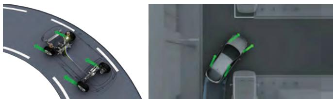
niskoj brzini, stražnji kotači okreću se u smjeru suprotnom smjeru prednjih kotača, čime se smanjuje kut okretanja i pruža potpora pri manevriranju na zatvorenim zavojima.
