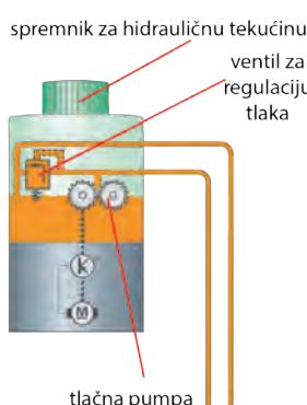
Načelo rada hidraulične zupčane pumpe temelji se na elektromotoru, čiji rotor služi kao pogonski zupčanik koji pokreće zupčanik praznog hoda. Ulije se uvlači kroz komoru izravno iz spremnika te se dalje pumpa u hidrauličnu krug.
