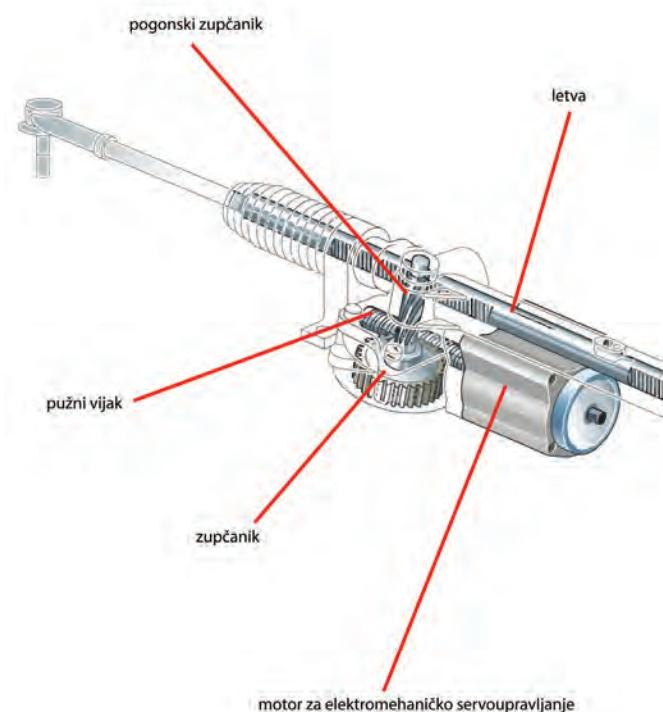
U tehnološkom pogledu servoupravljački sustavi kontinuirano su se razvijali, a hidraulični krugovi polako izlaze iz upotrebe zbog razvoja elektromehaničkih sustava kojima upravljaju kontrolne jedinice.
