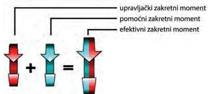
Zbog geometrije pogonskog sklopa kotači teže vraćaju u pravocrtni položaj. Ako je povratni moment sile veći od zbroja momenta sile na volanu i pomoćnog zakretnog momenta, servoupravljački sustav pokreće povratak u pravocrtan položaj.
