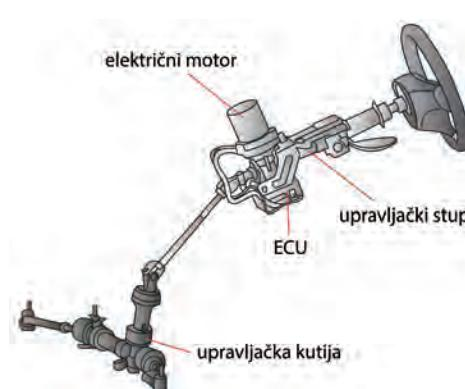
U ovom slučaju, pomoći pri upravljanju nalazi se na stupu upravljača te je pokreće električni motor. Ovaj servo-upravljački sustav pruža potporu kretanjama koje generira vozač.
