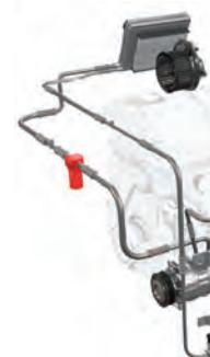
Filter sušač se nalazi u sklopu visokog tlaka i njegove glavne funkcije su da djeluje kao spremnik za tekućine u njihovom tekućem stanju, filtrira nečistoće iz sklopa prije nego dođu što do ekspanzijskog ventila, bilo zbog toga što je niska razina plina, vлага u sklopu ili je došlo do ekspanzije u samom filteru.
