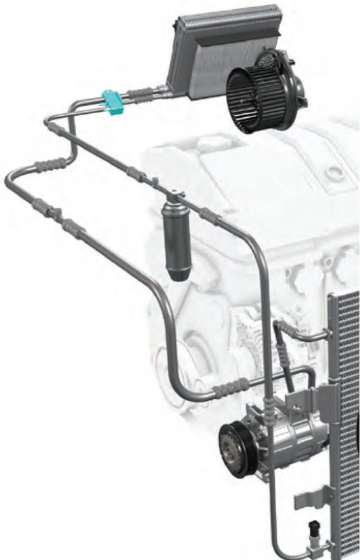
Umjesto ekspanzijskog ventila, moguće je koristiti drugi uređaj pod nazivom prigušni ili ventil s otvorom. Ova vrsta ventila ne dopušta regulaciju protoka, dakle mora se koristiti u kombinaciji s kompresorom promjenjivog kapaciteta da bi se strujanje tekućine moglo regulirati. Ima kalibrirani otvor što dozvoljava protok određenog postotka rashladne tekućine. To uzrokuje pad tlaka i dolazi do širenja tekućine.
