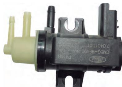
Elektromagnetski ventil za upravljanje turbopunjačem koji regulira tlak turbopunjača djelujući na vakuumski krug koji napaja pneumatski ventil. Njime upravlja upravljačka jedinica putem modulacije impulsnog signala mijenjanjem frekvencije ovisno o opterećenju motora.
