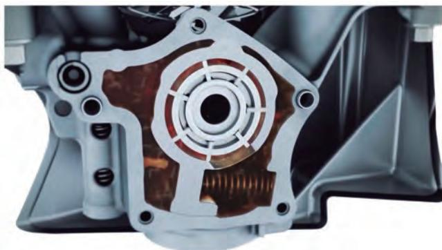
Crpka za ulje s promjenjivim protokom prilagođava količinu protoka potrebama motora u svakom radnom stanju. Ova vrsta crpki smanjuje gubitak mehaničke snage do 10 % smanjujući unutarnje trenje, i tako pridonosi uštedama goriva.
