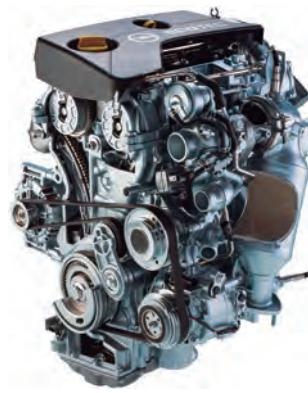
Ispušni razdjelnik je integriran u glavu cilindra, koja se nalazi vrlo blizu turbopunjaču s niskom inercijom. Ovakva konfiguracija omogućuje brzo punjenje motora za pružanje velike snage, pa je zato najveći okretni moment od 166 Nm, dostupan od 1800 o/min, gotovo 30 % veći nego u 1,6-litarskom motoru s prirodnom aspiracijom pri istim okretajima, a učinkovitost sagorijevanja je također 20 % veća.
