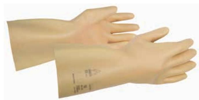
Prikladnost rukavica za rad pod visokim naponom određena je prisutnošću dvostrukog trokuta na izolacijskom materijalu, klasom i maksimalnim izolacijskim naponom prema uredbi i CE oznaci zajedno s identifikacijskim kodom certifikacijskog tijela.
