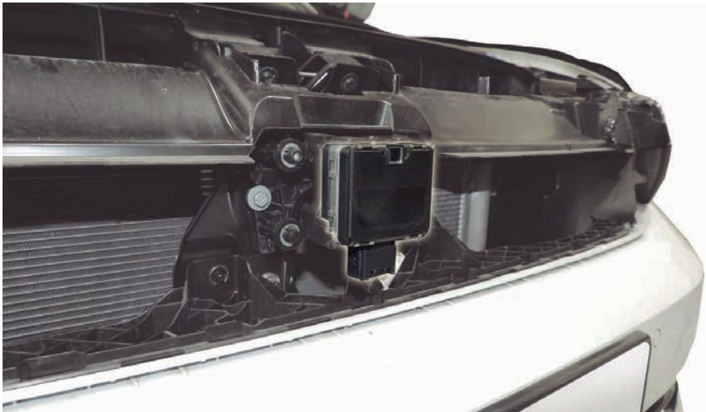
Glavni senzor sustava čini radar smješten na prednji dio vozila koji omogućuje detekciju vozila koja se kreću ispred njega te utvrđivanje udaljenosti između njih. Ovisno o inačici, radar je moguće nadograditi kamerom s pogledom prema naprijed ili laserskim senzorom.
