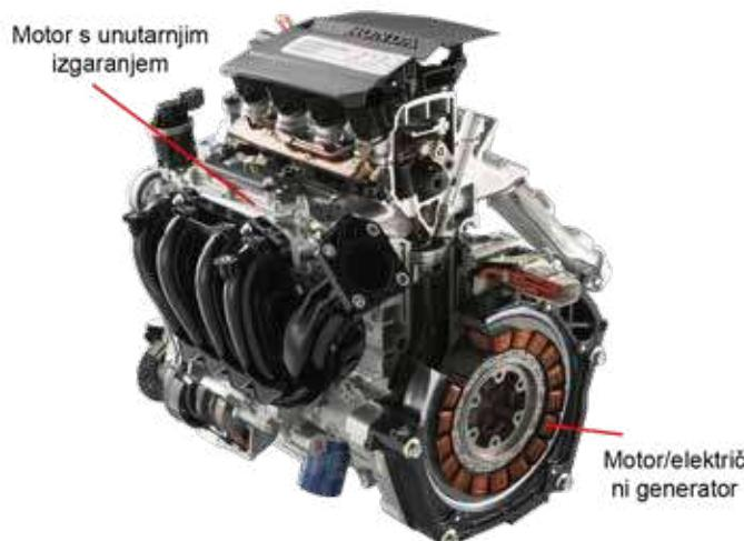
**Mehanika hibridnog vozila s paralelnim spojem
