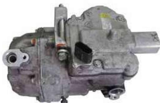
Kod ove vrste kompresora motor s unutarnjim izgaranjem ne gubi na snazi kada je spojen. Dodatna prednost koju nude jest da mogu nastaviti funkcionirati unatoč činjenici da je motor s unutarnjim izgaranjem zaustavljen, a mogu u svakom trenutku raditi i pri optimalnom broju okretaja, neovisno o tome da li vozač ubrzava, koči itd.
