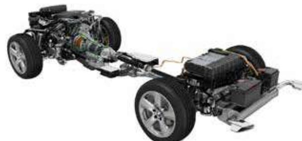
U većini slučajeva ideja je kombinirati motor s unutarnjim izgaranjem s elektromotorom. Svrha motora s unutarnjim izgaranjem je osigurati snagu za rad sustava vuče i povećati brzinu vozila kada se ono već kreće, dok je elektromotor zadužen za pojačavanje okretnog momenta motora i njegova je svrha početi ubrzavati vozilo nakon što se ono prethodno zaustavi.
