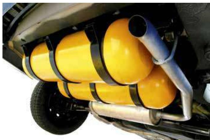
S druge strane, postoje i vozila na hibridna goriva. Ova su vozila opremljena motorom s unutarnjim izgaranjem koji može biti pogonjen dvjema različitima vrstama goriva, kao što je u slučaju **LPG-a** (ukapljenog naftnog plina) i **CNG-a** (komprimiranog prirodnog plina).
