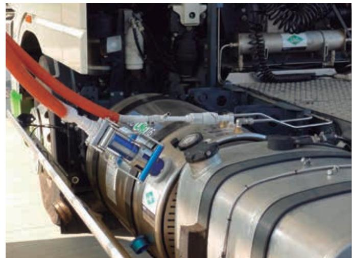
Na tržištu su dostupni kompleti za preradu koji omogućuju prilagodbu dizelskih motora sustavu plina, a u zemljama čiji propisi to dopuštaju dostupni su i dizelski motori koji su već pripremljeni za potpunu promjenu. Mnogi proizvođači teških vozila prodaju dizelske modele koji su tvornički opremljeni sustavima za rad s plinom, a koji su namijenjeni uporabi u funkciji posebnih industrijskih vozila za javne radove i ruderstvo.
