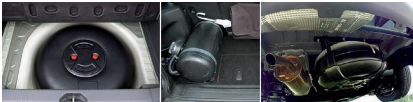
Gorivo se u tekućem stanju provodi kroz cijevi iz spremnika LPG-a sve do regulatora tlaka. U regulatoru se nalazi još jedan zaporni elektromagnetski ventil. Funkcija regulatora je **smanjiti tlak LPG-a na približno 1 bar, čime se stanje mijenja iz tekućeg u plinovito** kako bi se olakšalo doziranje istog za potrebe ubrizgavanja.
